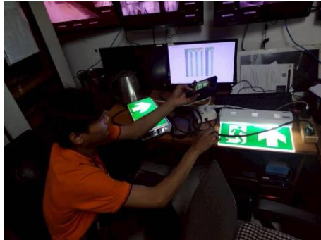
เจ้าหน้าที่ตรวจเช็คป้ายบอกทางหนีไฟ และไฟส่องสว่างฉุกเฉิน
